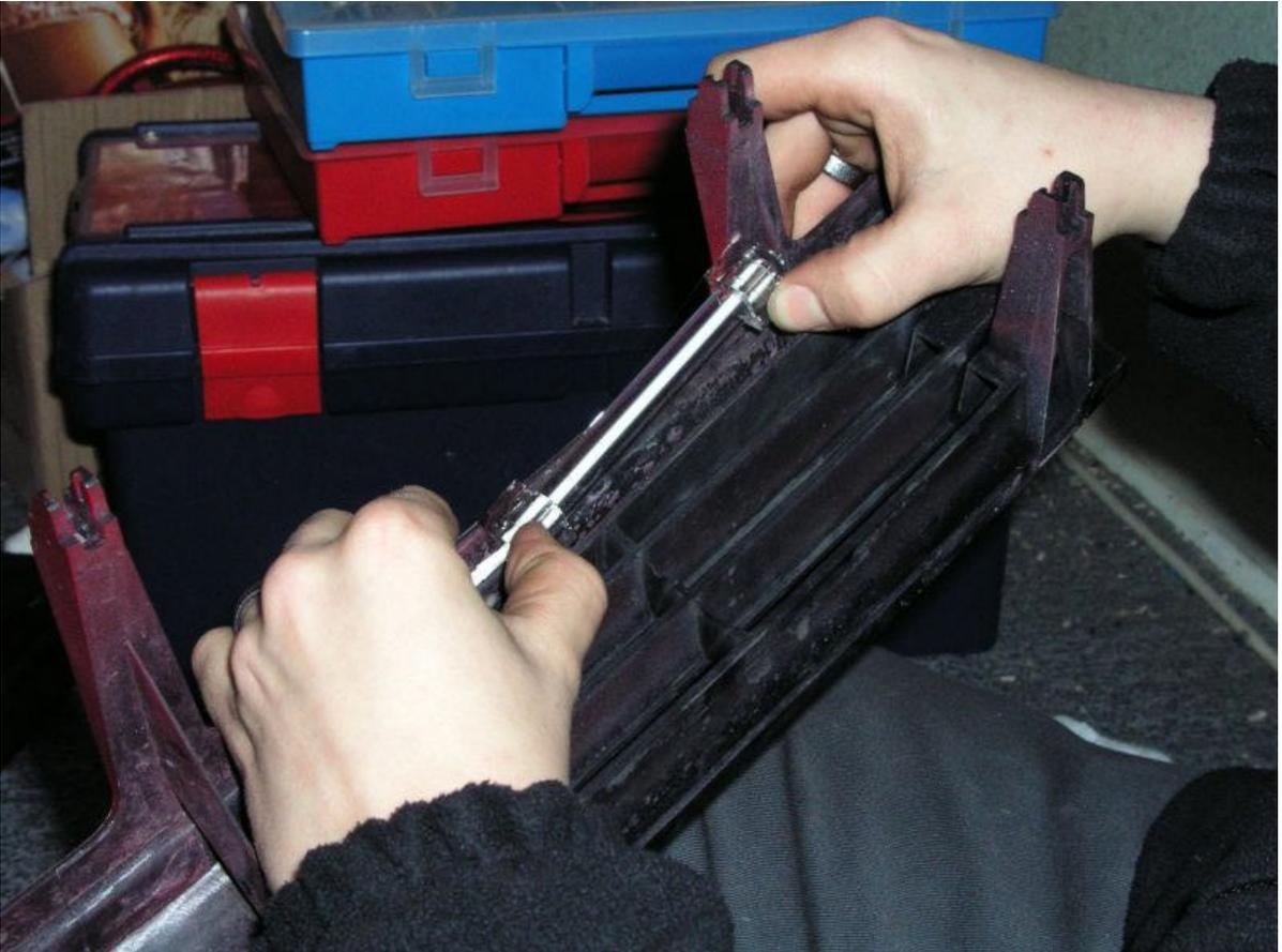
Wir haben Vorsichtshalber noch die Kathoden mit 2 Kabelbinder gesichert, falls der Kleber sich lösen sollte. Hier zu müssen Sie 2 Löcher pro Kaltlichtkathode in den Grill Bohren (Bohrer  $d = 4\text{ mm}$ )
