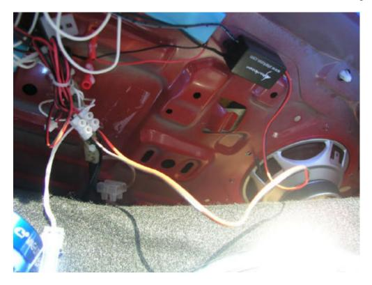
Der Inverter ist nun mit Strom versorgt. Zum testen kann man nun den Stringanschließen. Und sich das Ergebnis anschauen!
