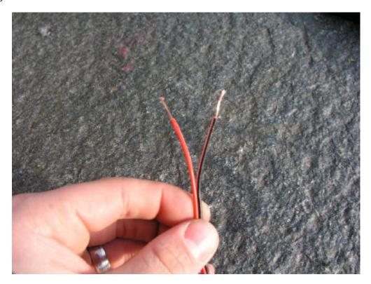
Bevor wir den Inverter anschließen, müssen wir uns Natürlich vergewissern, auf welchem Kabel der Kofferraumbeleuchtung Plus und Minus ist. Um das Herauszufinden Benutzt man eine Prüflampe.
