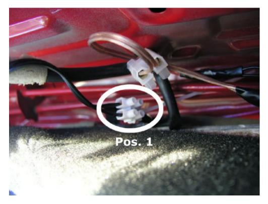
Der Kreis (Pos1) markiert den Strom von der Kofferraumbeleuchtung, an dieser stelle schließen wir den Inverter an den Strom an!
