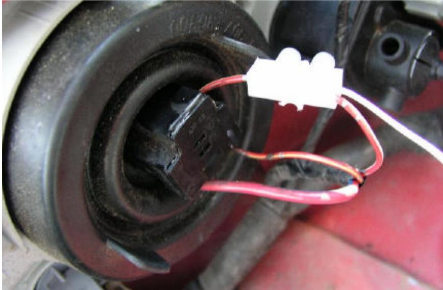
Nun müssen Sie insgesamt fünf Kabel vom Motorraum in den Innenraum ihres Fahrzeugs legen. Am besten wäre es, wenn man 2 Adrige Kabel mit einer Markierung benutzt, um hinterher Verpolungsfehler zu vermeiden.
