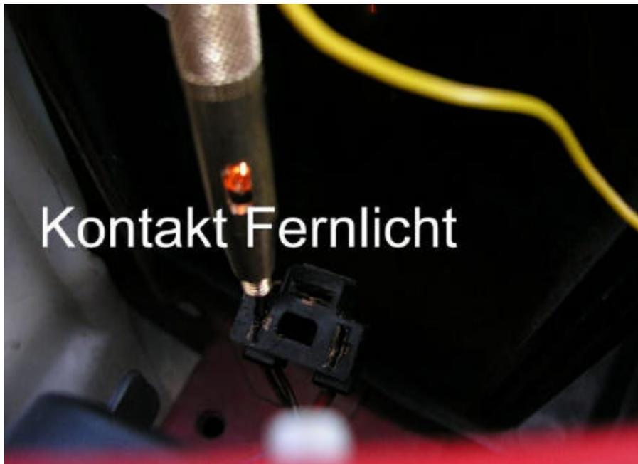
Als nächstes, schalten Sie zur Ihrer eigenen Sicherheit das Licht wieder aus. Stecken Sie nun den Stecker wieder auf ihre Glühbirne auf. Trennen Sie nun mit einem Seitenschneider das Stromkabel, das ihr Fernlicht mit Strom versorgt. Isolieren Sie nun ca. 5 bis 10 mm von beiden Kabeln ab und verbinden diese mit einer Lusterklemme. Denn hinterher wird an dieser Stelle die Soundsteuerung für unsere LEDs angeschlossen.
