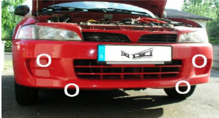
Wir werden in diesem Workshop die LED Strahler über eine Soundsteuerung anschließen. Die Soundsteuerung bekommt ihren Strom dieses Mal NICHT vom Radio, Zündung etc, sondern von der Stromversorgung des Fernlichts.
