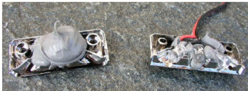
Die LEDs einsetzen und beide Hälften wieder zusammensetzen.
